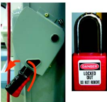
Rysunek 1-32 Blokowanie dźwigni wyłącznika
