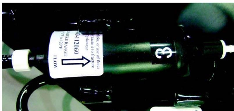
Rysunek 6 - 38 Instalowanie nowego filtra
