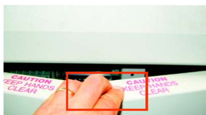
Figure 1-27 Niebezpieczeństwo zatrzaśnięcia przez drzwiczek szafki
