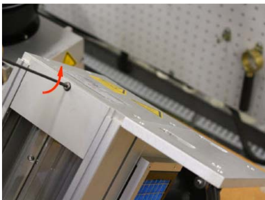
Rysunek 6 - 22 Zdejmowanie tylnej płyty szkła kwarcowego
