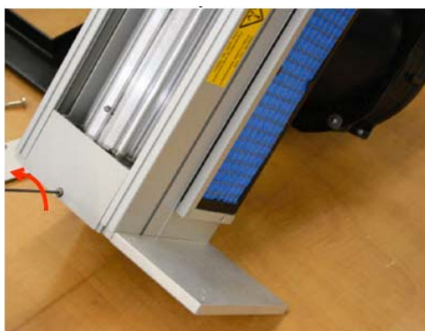
Rysunek 6 - 20 Zdejmowanie płyty szkła kwarcowego
