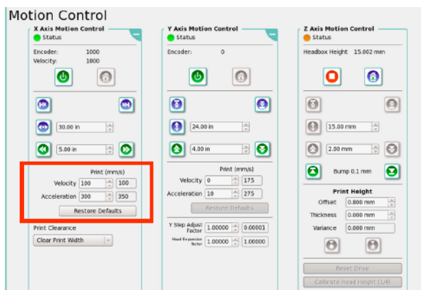
Rysunek 5 - 90 Ustawienia prędkości i przyspieszenia ruchu stołu
