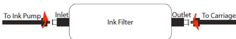
Rysunek 6 - 36 Odłączanie filtrów atramentu od system pompowania
