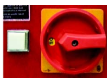
Rysunek 5 - 1 Główny wyłącznik zasilania
