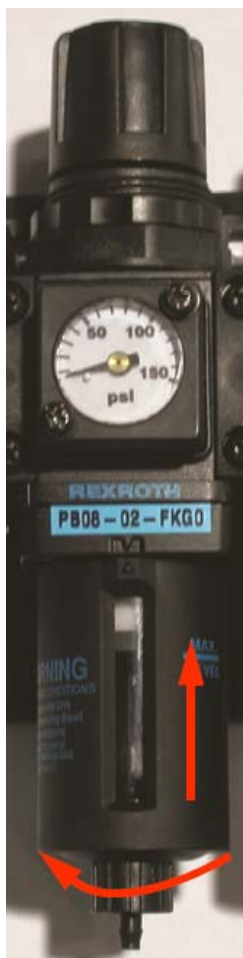
Rysunek6 - 71 Konserwacja separatora wody
