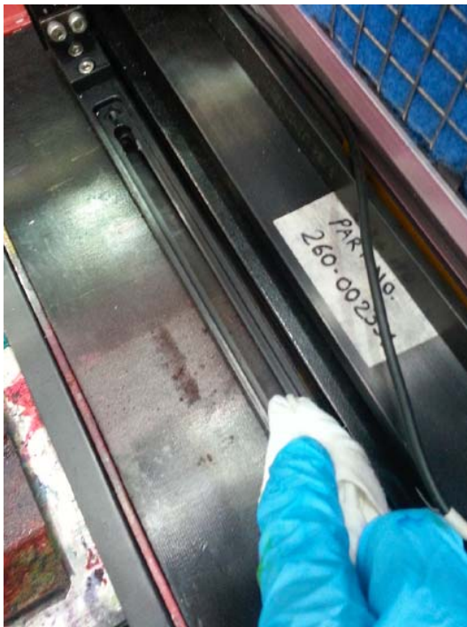
Rysunek 6 - 86 Czyszczenie gniazda czujnika.
