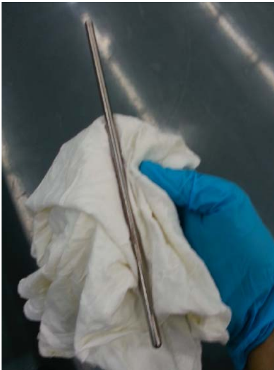
Rysunek 6 - 85 Czyszczenie czujnika zderzenia
