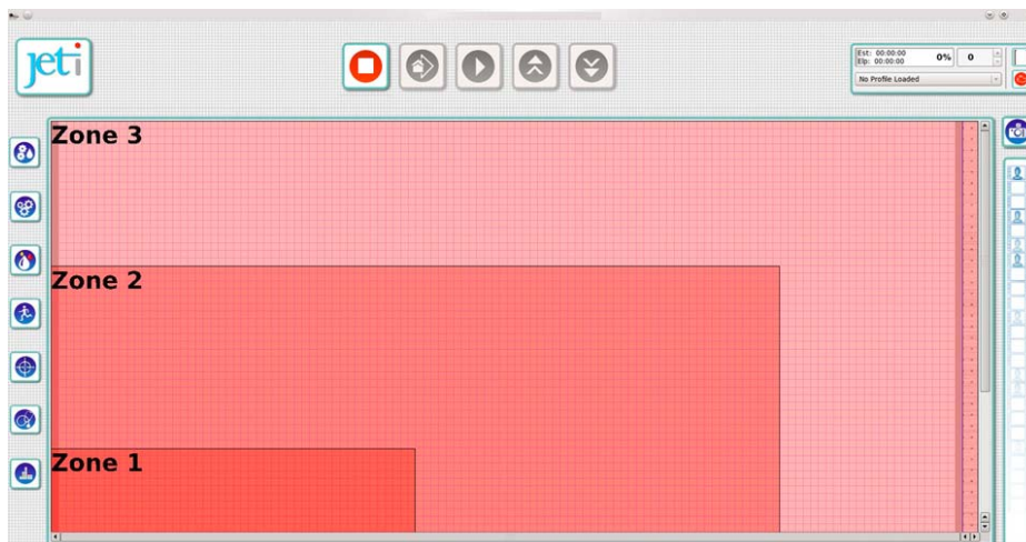
Rysunek 5 - 26 Układ stref podciśnienia na stole
