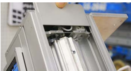
Rysunek 6 - 27 Ponowne instalowanie płyty oraz szkła kwarcowego
