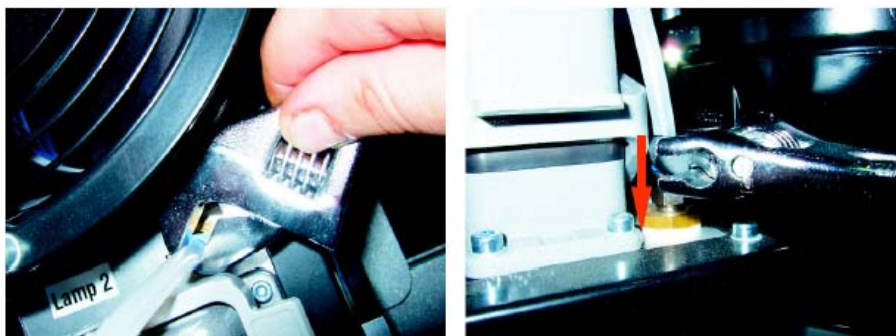
Rysunek 6 - 3 Odłączanie przewodu sprężonego powietrza od modułu lamp UV
