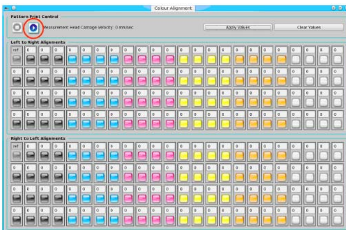
Rysunek 5-118: Wzór testu wyrównania kolorów
