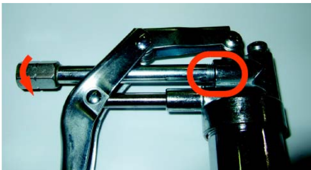
Rysunek 6 - 61 Instalowanie rurki smarowniczej w smarownicy
