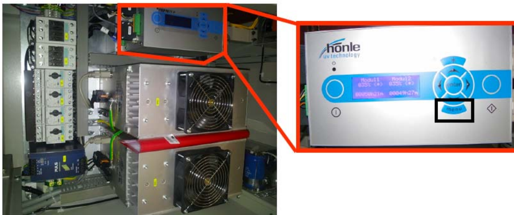
Rysunek 6 - 1 Liczniki systemu utwardzania UV
