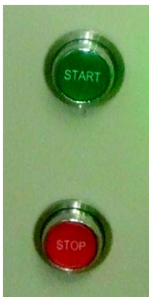
Rysunek 5 - 14 Przyciski włączające/wyłączające silnik stołu
