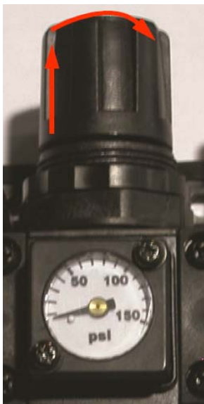
Rysunek 6 - 72 Nastawianie regulatora powietrza
