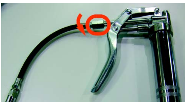
Rysunek 6 - 62 Instalowanie elastycznej rurki smarowniczej
