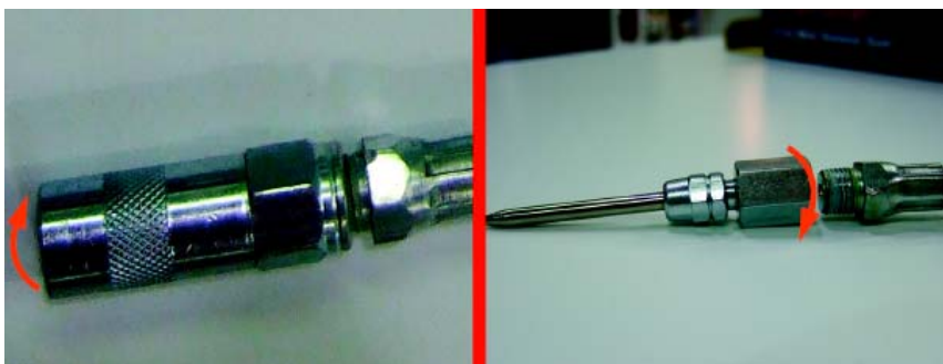
Rysunek 6 - 63 Instalowanie końcówki igłowej
