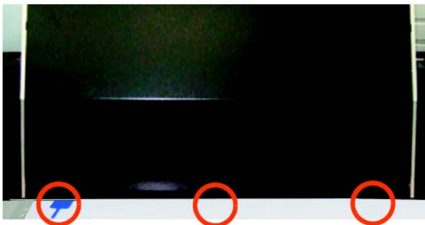
Rysunek 5 - 106 Weryfikacja wysokości karetki przy użyciu przyrządu do pomiaru grubości
