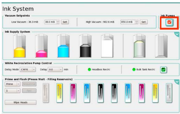
Rysunek 6 - 34 Odłączanie pomp
