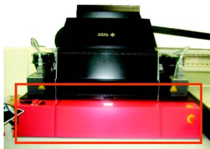
Figure 1-27 Niebezpieczeństwo zatrzaśnięcia przez drzwiczek szafki
