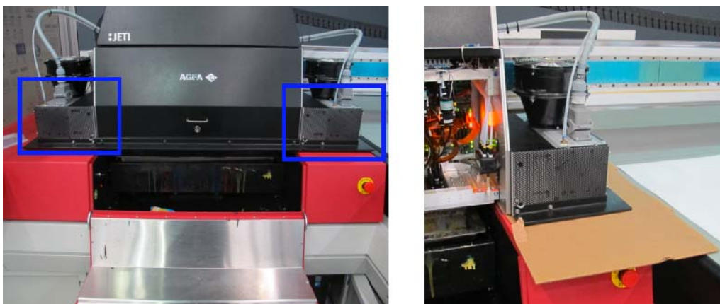
Rysunek 6 - 5 Układanie kartonu bądź rdzenia piankowego pod moduły lamp UV
