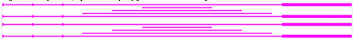
Figure 5-121 Odczytywanie wzoru 4: pionowe wyrównanie płyty głowicy
