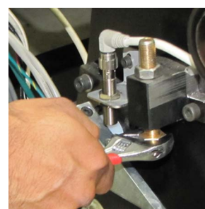
Regulacja mechanizmu twardego zatrzymywania rolki dociskowej
